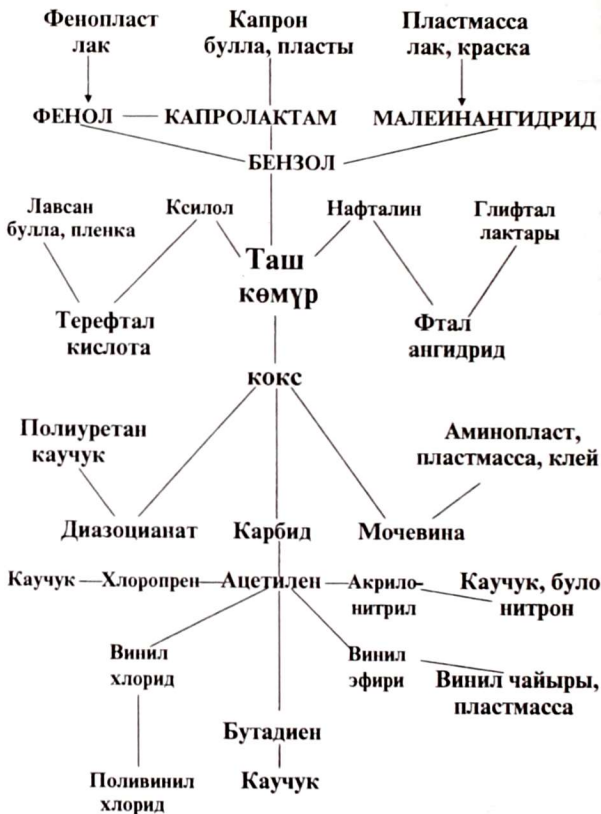
Сүрөт 9. Таш көмүрдү иштетүүдөн полимерлерди синтездөөнүн схемасы
